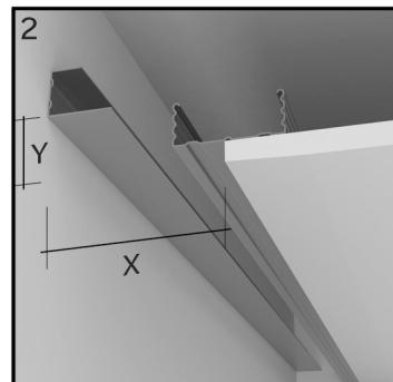
install metal beams for plasterboard according to the dimensions of the given table/τοποθετήστε μεταλλικούς οδηγούς σύμφωνα με τις διαστάσεις του πίνακα
