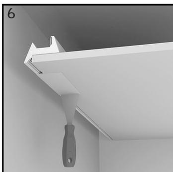
apply 1<sup>st</sup> layer of joint filler
